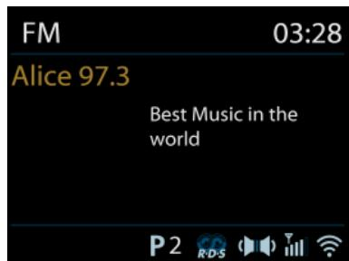
Pour trouver une station, appuyez sur le bouton rotatif ou sur OK (SCAN) de la télécommande. L'affichage de la fréquence s'illumine pendant que le REGENT i450s recherche la bande FM. Vous pouvez également effectuer une recherche vers le haut ou vers le bas en maintenant les boutons enfouis, ou régler manuellement la fréquence en appuyant brièvement sur le bouton rotatif ou en le tournant.
