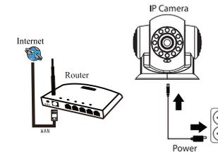
1. Klemmen Sie die Kamera an die Stromversorgung an (in der Nähe eines WLAN-Routers; mit Hilfe angeschlossene den Netzadapter);
