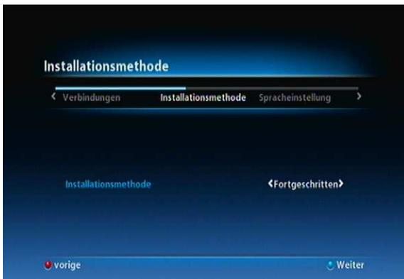
5. Bei Wahl der “fortgeschrittenen” Installationsmethode können Sie folgende Einstellungspunkte bestimmen: Tonspur-, und Untertitelsprache. Die einzelnen Punkte wählt man mit “◀/▶” Tasten. Zum nächsten Fenster gelangen Sie, indem Sie die “blaue” Taste wählen.
