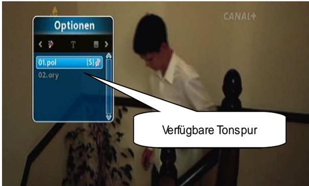
2. Mit Hilfe der Tasten "▲▼" wählen Sie die gewünschte Tonspur aus und bestätigen die Wahl mit "OK". Der Receiver schaltet dann auf die gewählte Tonspur um. Wenn Sie trotz ausgewählten Dolby Digital AC3 Tonspur keinen Ton bekommen, prüfen Sie ab der angeschlossene Fernseher/Verstärker den dekodierten Dolby Digital AC3 Standard unterstützt.
