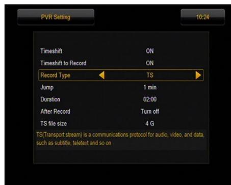
Weiter in diesem Untermenü können Sie den Dateiformat der Aufnahmen festlegen. Sie können den kompletten Datenstrom als TS (Transport Stream) aufnehmen, oder nur die erste Tonspur und Bild als PS (Program Stream) aufnehmen. Wir empfehlen den TS, da alle Tonspuren, Untertitel und der Videotext mit aufgenommen werden (mehr Speicher wird benötigt).
