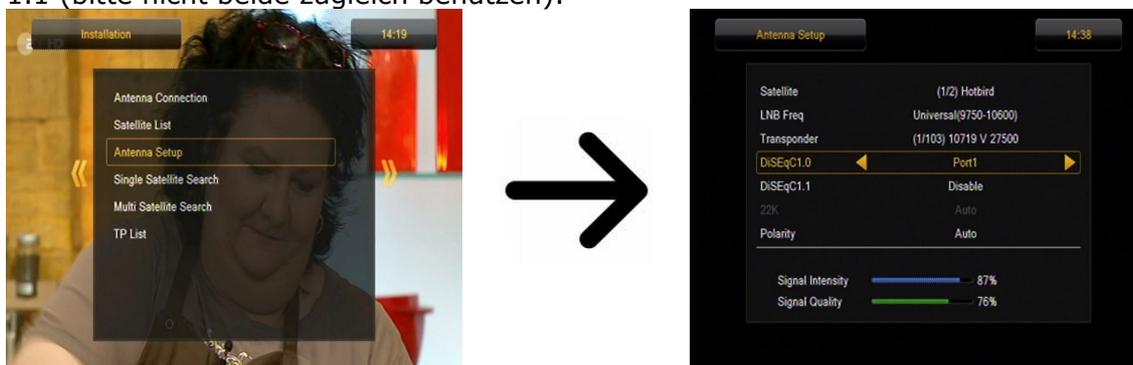
Eine korrekt ausgerichtete und eingestellte Schüssel zeigt Signalstärke und Signalqualität an. Beide Streifen sollten mindestens 80% anzeigen, um einen tadellosen Empfang von HDTV zu gewährleisten. Um gewünschte Transponder zu überprüfen, gehen Sie bitte zu der Position „Transponder“ und ändern die Frequenz.
