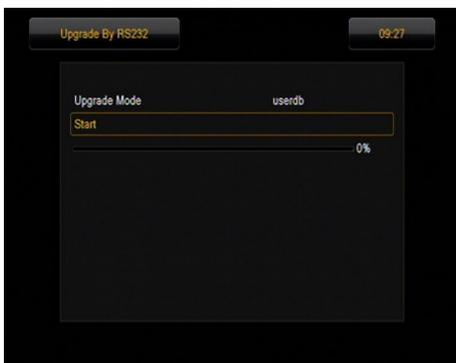
In diesem Untermenü können Sie Firmware oder Senderliste vom Receiver zum PC oder zu einem weiteren (gleichen) Receiver senden. Schließen Sie beide Geräte mit einem RS232 „Null Modem“-Kabel aneinander. Wählen Sie bitte **allcode** für die Firmware, oder **userdb** für die Settings (Einstellungen) und Senderliste.
