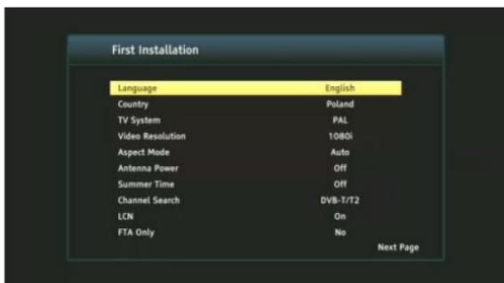
Gehen Sie nach Auswahl der Einstellungen zum „nächsten“ Punkt und bestätigen Sie mit der „OK“-Taste. Das Signal von der Antenne wird gescannt.
