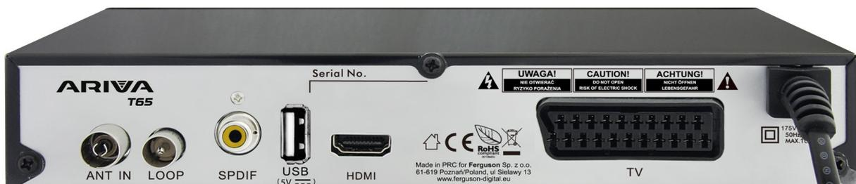
**ANT IN:** Eintrag in das Koaxialkabel von der Antenne.
