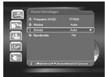
**Frequenz:** Leuchten Sie den Punkt auf, dann drücken Sie die ► Taste zum Aktivieren. Wählen Sie die gewünschte Stelle aus. Durch Drücken der ▲▼ Tasten auf der Fernbedienung können Sie den Wert der gewünschten Stelle verändern. Danach drücken Sie die **OK** Taste zur Bestätigung, oder drücken Sie die **EXIT** Taste zum Löschen.
