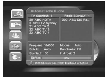
Während des Sucheprozesses wird die **OK** Taste benutzt, um in den gegenwärtigen RF Kanal zu springen und die **EXIT** Taste benutzt, um alle Prozesse zu beenden. Nach der Suche werden die neu gefundenen Fernseh- und Radio Programme in der entsprechenden Programmliste gespeichert und in Kategorien arrangiert.
