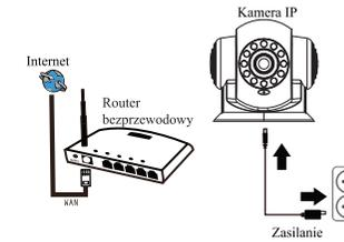
1. Hay que conectar la cámara con la fuente de alimentación (a través de la fuente de potencia que viene incluida), a continuación por el cable LAN conectarla con el enrutador.
