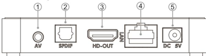
1. Uscita AV - per dispositivi analogici. Jack 3,5/17,5mm 4-pin.
